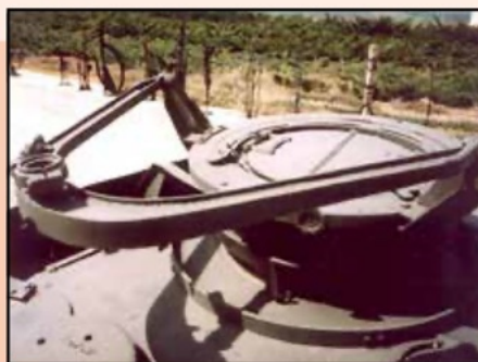
De Tsjechoslowaakse affuit voor het DShK machinegeweer tegen luchtdoelen en de aanpassing voor de koepel van een Panzer IV
