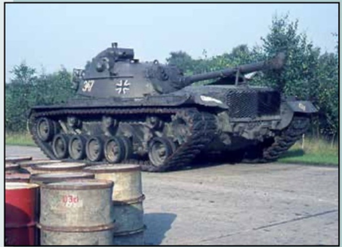
▲ Een bij de Tankwerkplaats afgeleverde Duitse M48A2 Pattontank met ontbrekend loopwiel.
